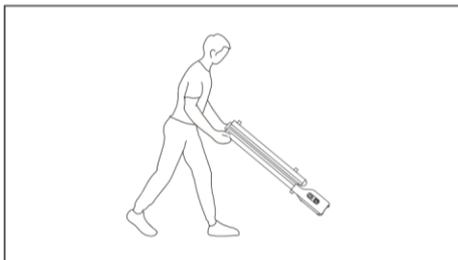
**1. Как показано на рисунке, поднимите оборудование с задней части передней панели для ходьбы.**
